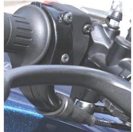
**Bremsflüssigkeitsausgleichsbehälterhalter** mit der Schraube M6x25 an der oberen Verschraubung der Klemmbriede befestigen, so dass der Ausleger nach links zeigt. Das Reservoir mit der originalen Schraube M6x15 und der Mutter M6ss am Halter befestigen.
